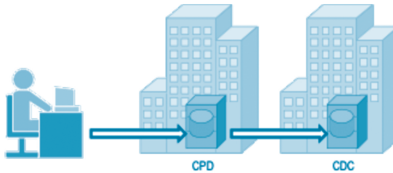
Figura 7.5. Proceso de mirroring al actualizar un usuario la información
