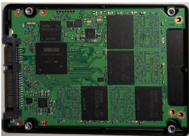
Izquierda: Interior de SSD de 2,5". Derecha: SSD conector m.2
