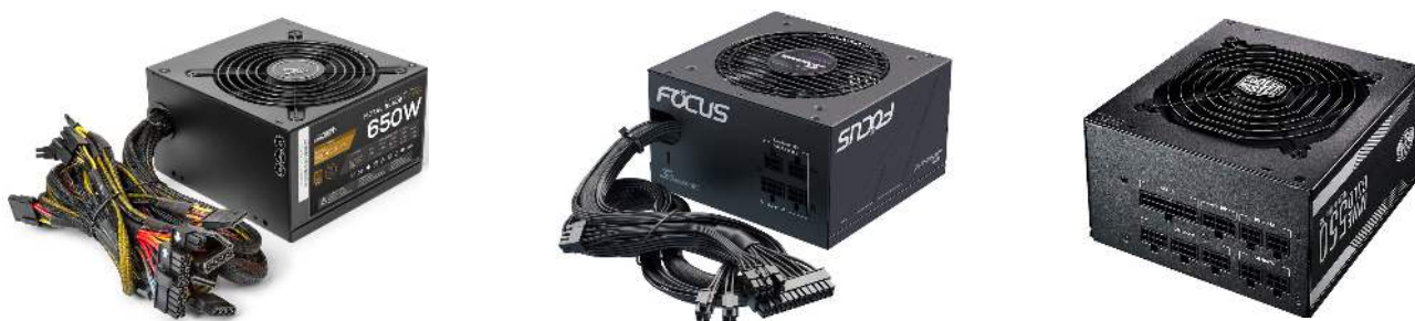
Fuentes de alimentación con cableado completo, semi-modular y full-modular.
